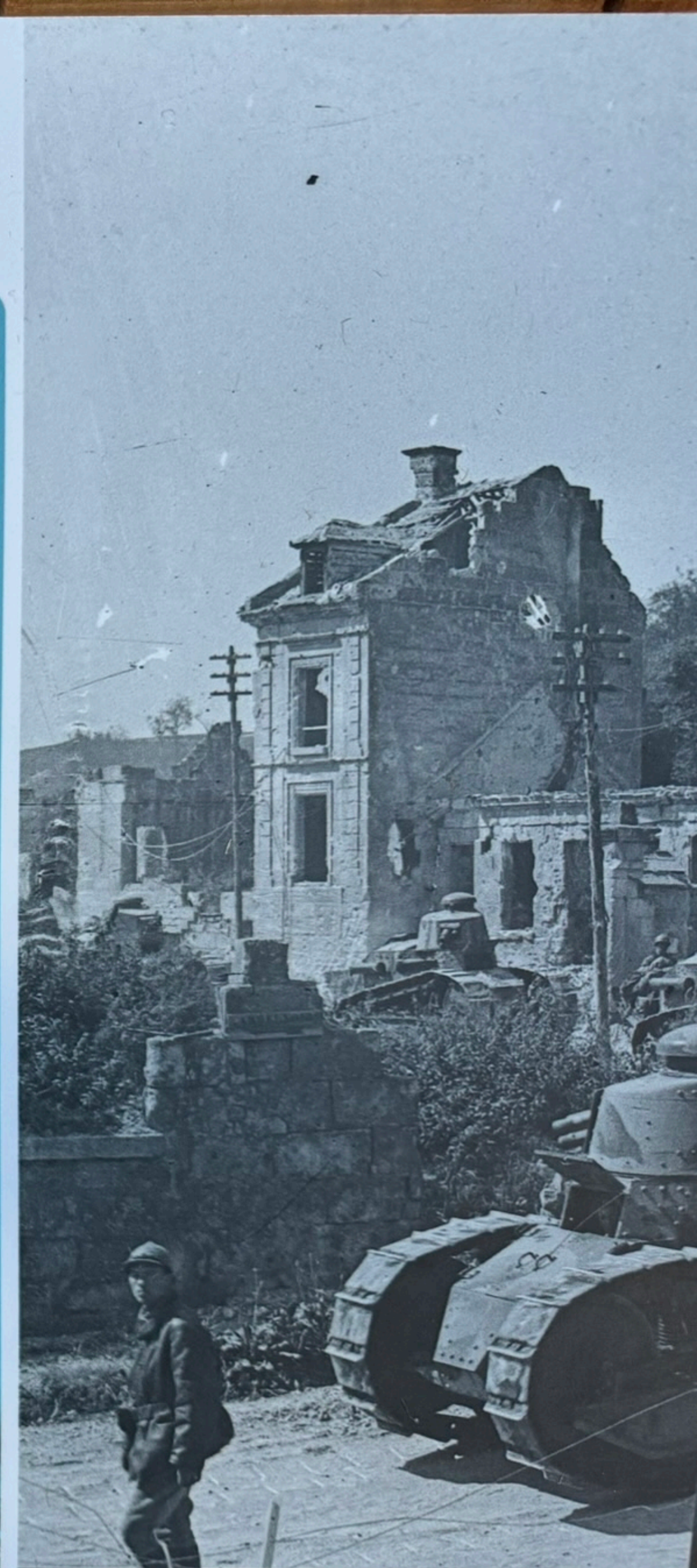
Une colonne de FT en route vers le front. Seul le premier et le quatrième ont une tourelle boulonnée. En attendant que celle-ci soit produite en quantité suffisante, mille FT comme les chars suivants dans la colonne. A column of FT on their way to the front. Only the first and the fourth have a bolted turret, like the next tanks in the column.
